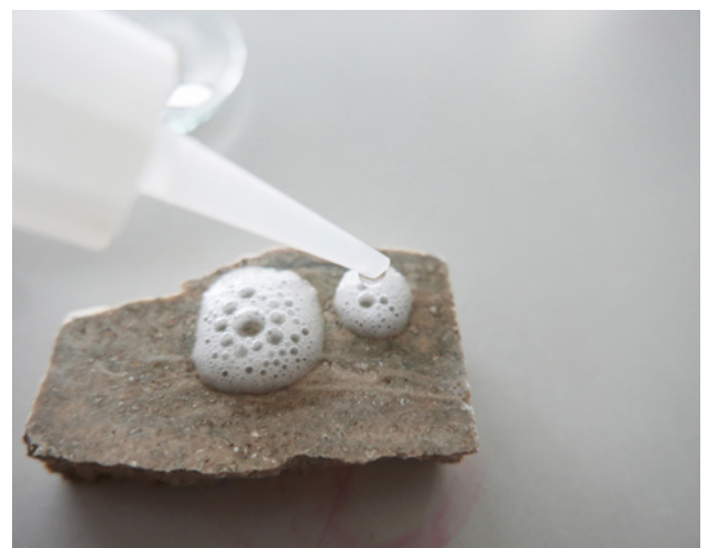
Abbildung 23: Kalknachweis mit Säuretest: Beim Auftropfen von Salzsäure auf Kalkstein sprudelt Kohlendioxid.
