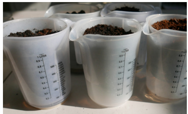
Abbildung 12: exemplarische Versuchsergebnisse zum Wasserhaltevermögen, das Volumen des Sickerwassers aus den Töpfen kann abgelesen werden am Messbecher
