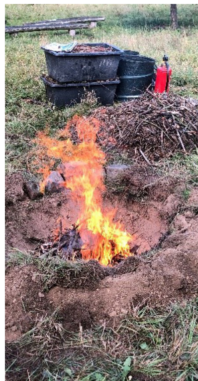
Abbildung 2: Herstellungsprozess von der Pflanzenkohle
