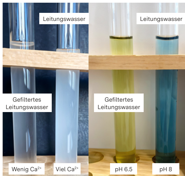
Abbildung 6: Vergleich von pH-Wert (Bromthymolblau) und relativer Calciumionenkonzentration zwischen Leitungswasser und „gefilitertem“ Wasser.
