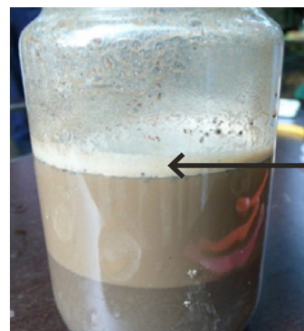
Abbildung 11: Die Dicke der Schaumschicht nach dem Schütteln zeigt den Humusgehalt in einem Glas mit Erde und Wasser an. Arbeitsblatt: Chemie im Alltag
