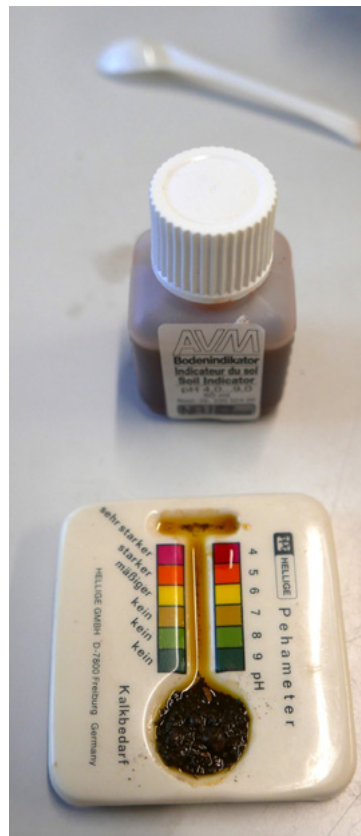
Abbildung 5: Benutzung des Hellige-pH-Meters Schritt 1: Boden mit Testflüssigkeit befeuchten, schräg halten
