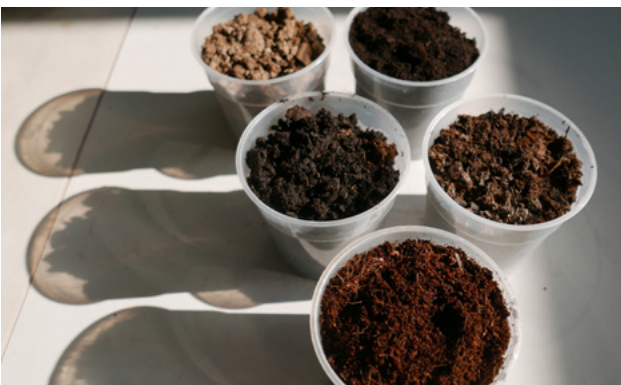
Abbildung 11: Versuch der Wasserhaltefähigkeit: Die verschiedenen Erden sind in Töpfe gefüllt.
