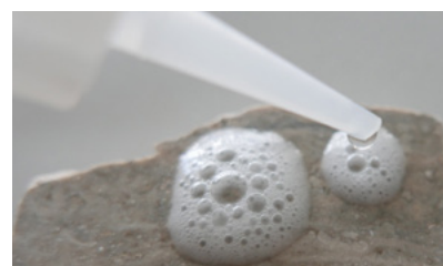
Abbildung 13: reiner Kalkstein sprudelt beim Auftropfen von 10%iger Salzsäure stark, \text{CO}_2 wird frei
