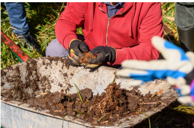
Abbildung 8: Durch Kneten kann man die Bodeneigenschaften prüfen – Lehm lässt sich formen
