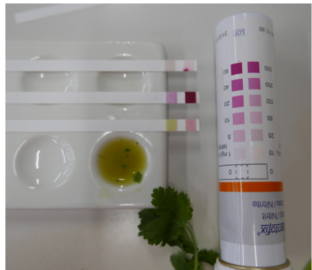
Abbildung 14: Teststreifen zur Bestimmung des Stickstoffgehaltes im Versuch
