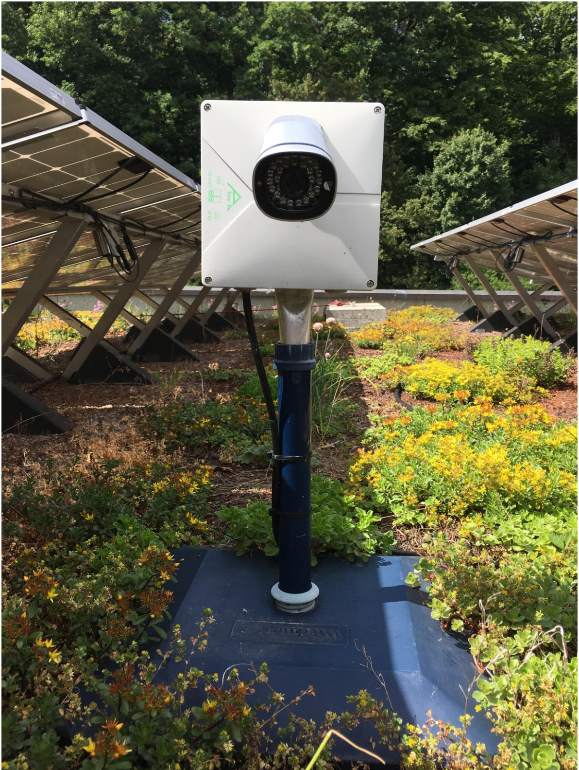
Kamera zur Feststellung der Bewuchsdichte und Schneebedeckung
