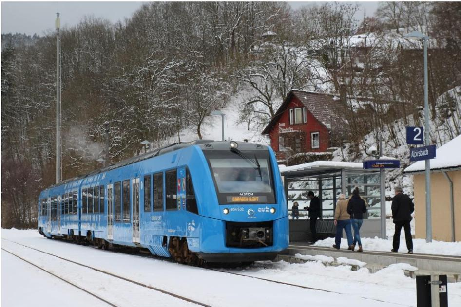
Triebwagen mit Brennstoffzellen- oder Batterietechnik sind eine Alternative für Bahnstrecken, deren Elektrifizierung zu kostspielig ist. Eine solche alternative Antriebstechnologie soll voraussichtlich Anfang der 2020er-Jahre im Netz der Ortenau-S-Bahn zum Einsatz kommen
