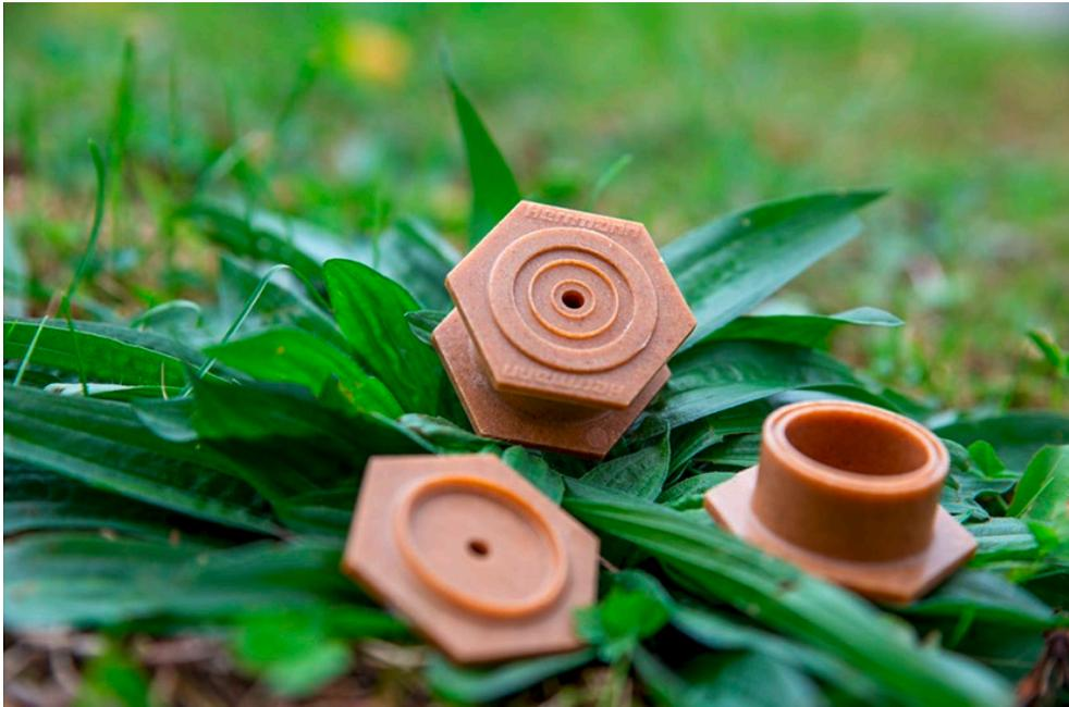
*Foto: Mit dem standardisierten Herrmann Probekörper wird die Fügefähigkeit von holz-basierten Bio-Kunststoffen erforscht.*
