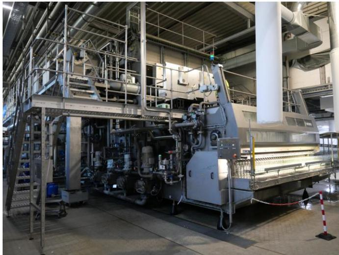
Flaschenreinigungsmaschine in der Glas-Mehrweg-Abfüllanlage.
