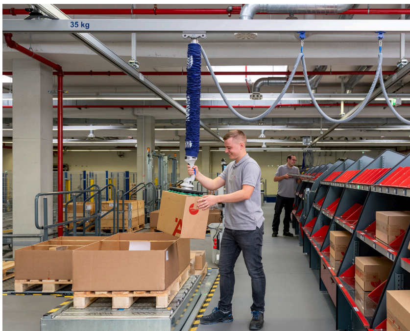
Ergonomischer Arbeitsplatz in der Kommissionierung
